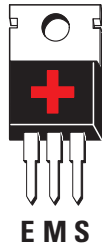
Figure 32 : Les circuits intégrés dont la référence commence par "78" servent à stabiliser des tensions positives.
